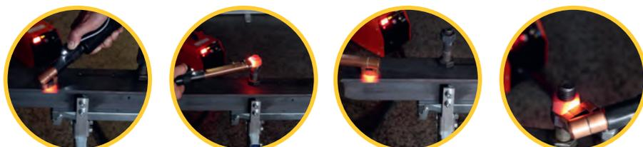
Chauffe avec précision tous les types de pièces métalliques, comme les petits composants d'entraînement, les logements de roulements, les écrous, les boulons, les tubes et les petites surfaces.
