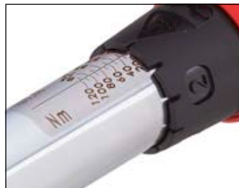
Graduation de l'échelle : 1 Nm
