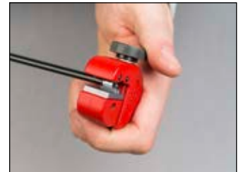
Positionnement de la conduite, afin de racler la gaine
