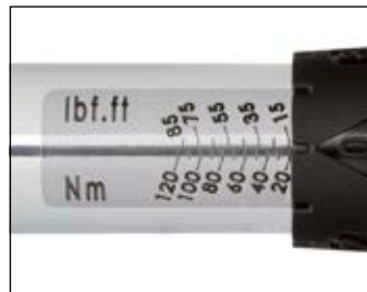
Double échelle : Nm et lbf.ft.
