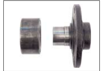
Unités de roulement de roue vissées à 3 boulons
