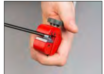
Positionierung der Leitung um Ummantelung abzuschaben
