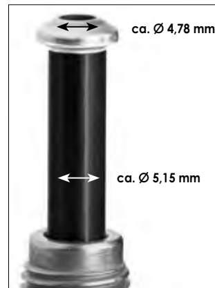
Positionierung der Leitung um Ummantelung abzuschaben
