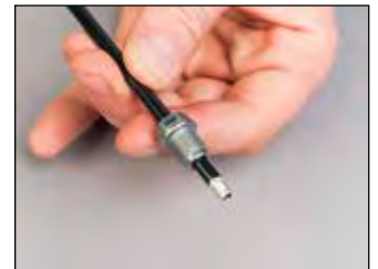
Aufstecken der Überwurfmutter
